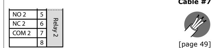
Fig. 4.18 Raccordement des sorties de relais
