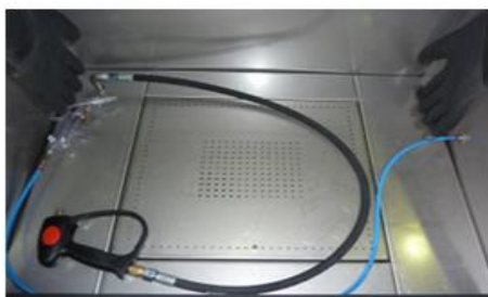
Leveres med fotmanøvrert spylepistol og blåse pistol med trykkluft
