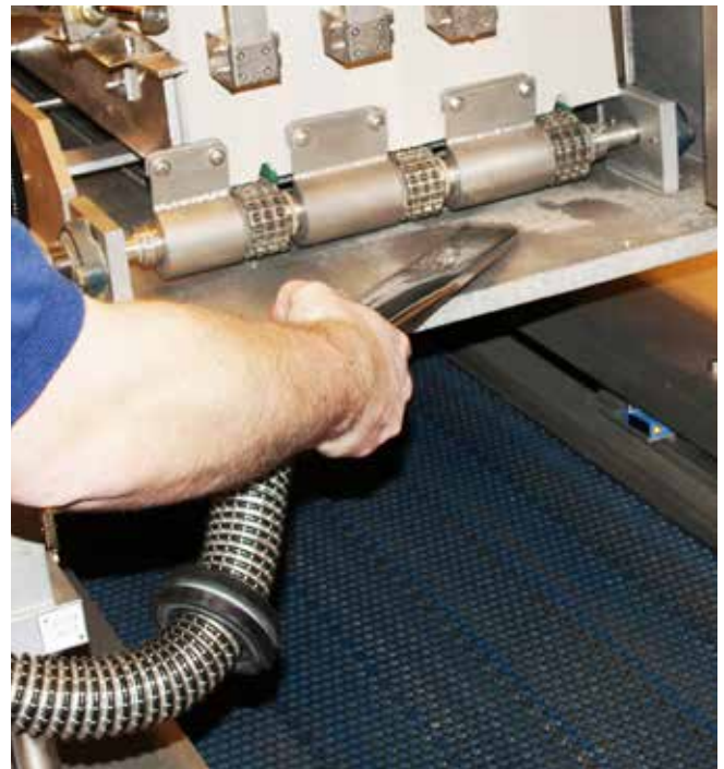
Maskinoperatören, Mikael Persson, dammsuger rent produktionslinan från glasskärvor som kan uppstå om flaskorna ej hamnar rätt och går sönder.
