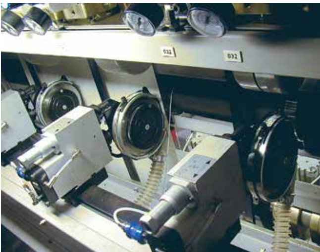
Sugkåpa monterad på kniv i en tryckpress.
