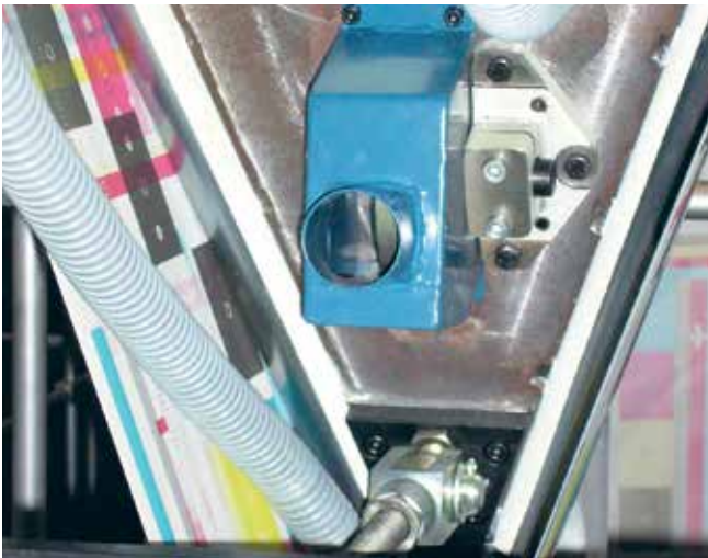
Sugkåpa monterad på kniv i en tryckpress.
