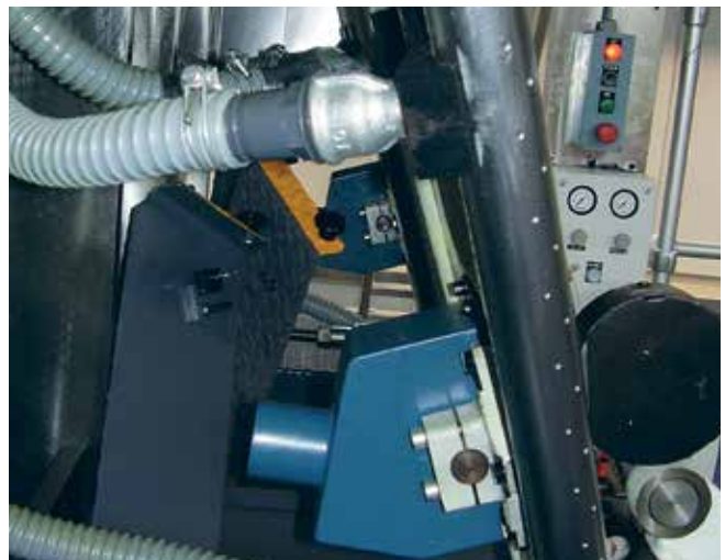
Sugkåpa monterad på kniv i en tryckpress.
