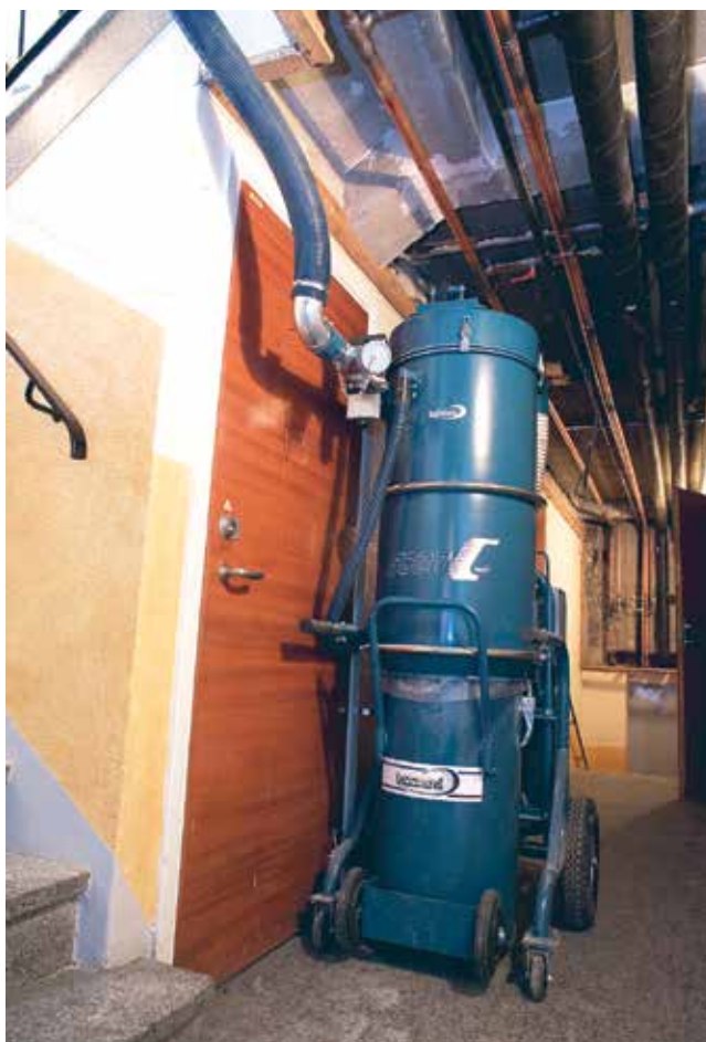
Slipmaskin försedd med en sugkåpa och luftrenaren DC AirCube som backup.
