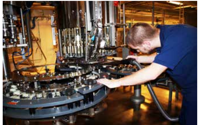
Maskinoperatören, Mikael Persson, dammsuger rent produktionslinan från glasskärvor som kan uppstå om flaskorna ej hamnar rätt och går sönder.
