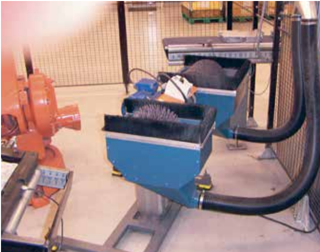
Sugkåpan samlar in stoft från automatisk gradborstning
